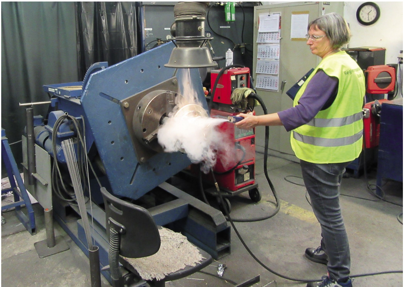
Abbildung 22: Die Wirksamkeit der technischen Absaugung muss regelmäßig überprüft werden, beispielsweise kann die Luftströmung mit einem Nebelgenerator sichtbar gemacht werden.
