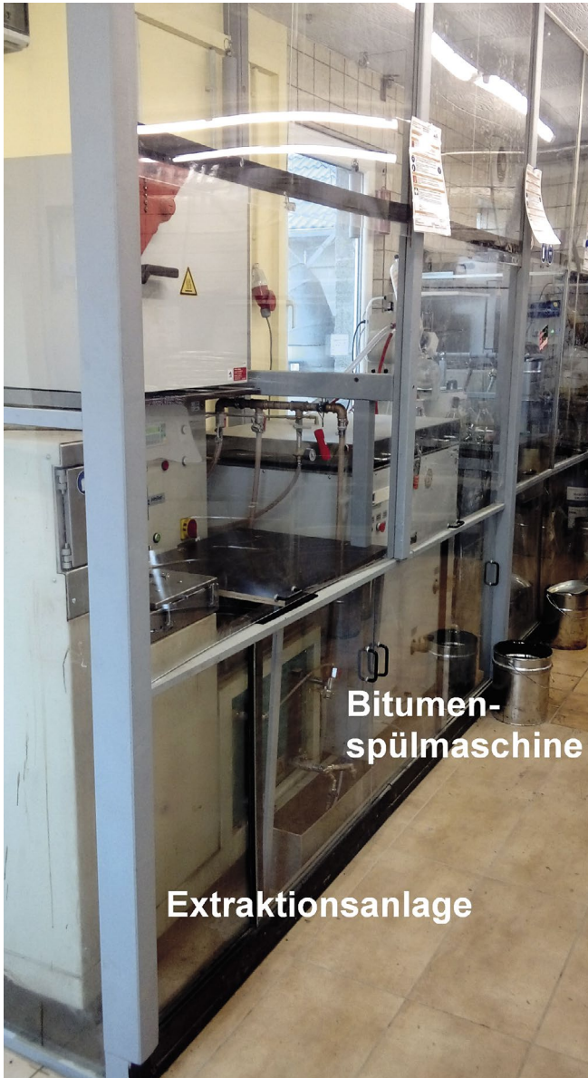
Abbildung 24: Beispiel für eine abgesaugte, wirksamkeitsüberprüfte Einhausung für Extraktionsanlagen nach dem Waschtrommelverfahren. Zusätzlich befinden sich in der Einhausung eine geschlossene Bitumenspülmaschine, ein Trockenschrank sowie zwei Rotationsverdampfer.
