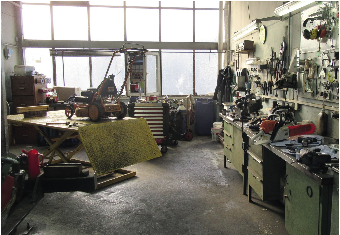
Abbildung 27: Werkstatt für Garten-, Forst- und Kommunalgeräte: Werden Gartengeräte, beispielsweise Rasenmäher mit benzolhaltigem Normalkraftstoff (Benzin) betankt, können Beschäftigte bei Arbeiten an kraftstoffführenden Teilen durch Einatmen und durch Hautkontakt gegenüber Benzol exponiert werden. Nur durch Verwendung benzolfreier Sonderkraftstoffe (Alkylatbenzin) kann die Belastung der Beschäftigten vollständig vermieden werden.
