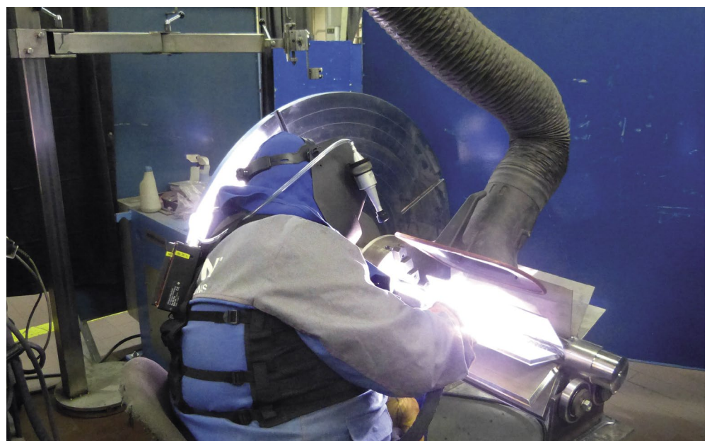
Abbildung 21: Eine optimale Positionierung des Erfassungselements der Absaugung beim Schweißen führt zu einer deutlichen Minimierung der Schweißrauchbelastung.
