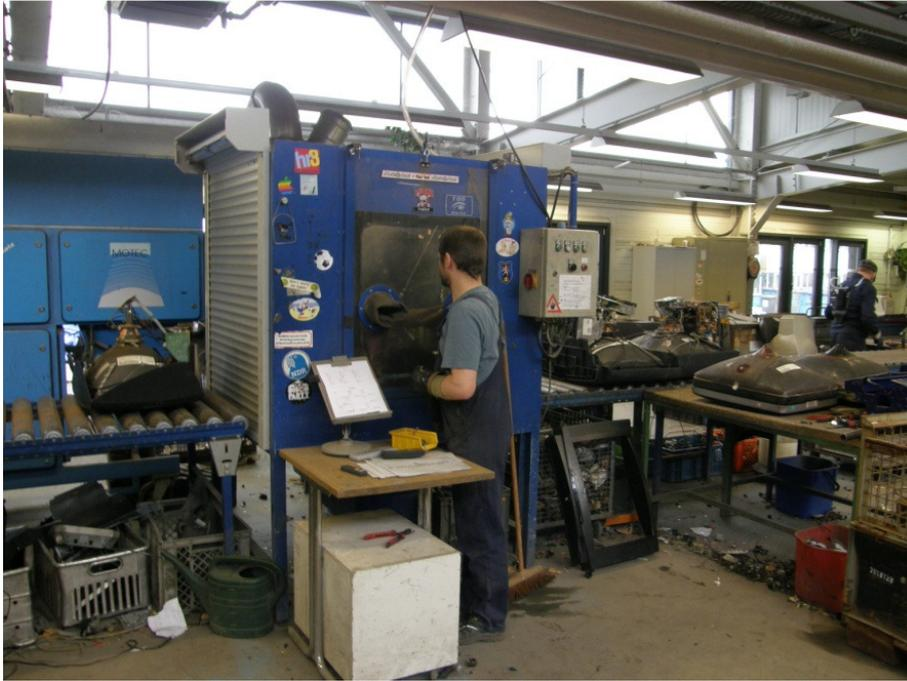
Abb.2: Reinigungsarbeiten in der Reinigungskabine (Quelle: RP Kassel)
