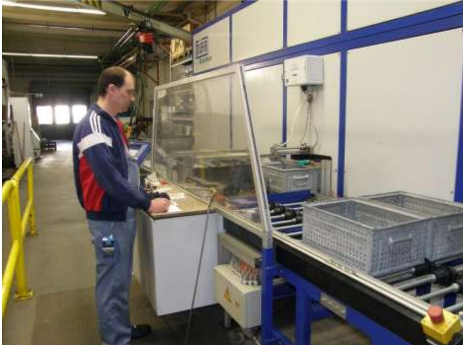
Abbildung 1: Einkammeranlage; Be- und Entladung der Arbeitskammer (RP Kassel)
