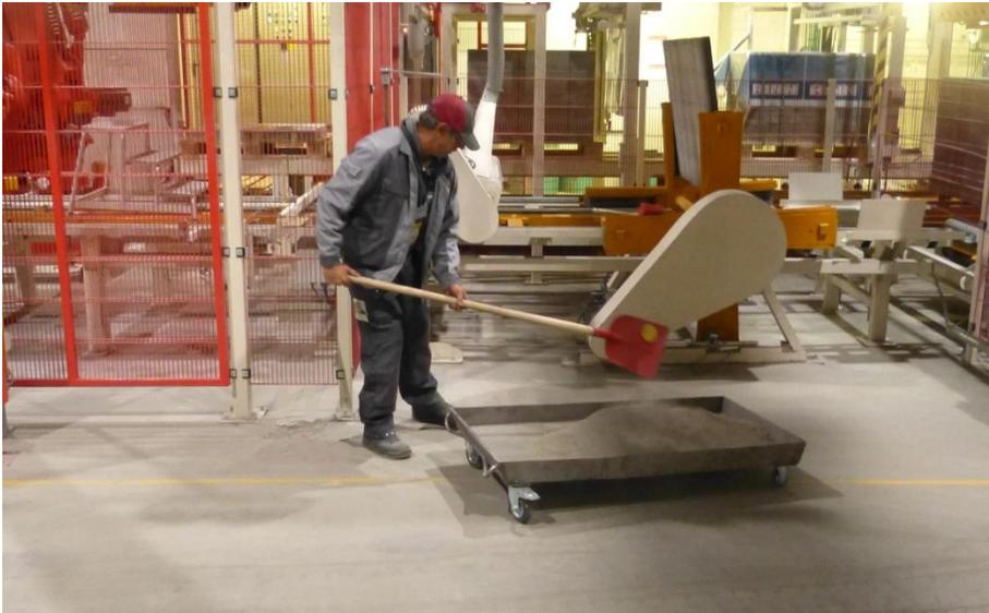
Abbildung 18: Entfernen von groben Staubteilen im Bereich eines abgesaugten Brettwenders
