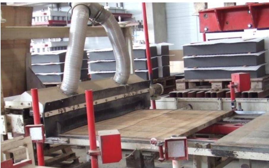
Abbildung 15: Absaugung bei der Brettreinigung
