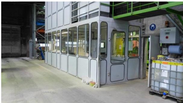
Abbildung 3: Steuerstand einer Fertigungsanlage
