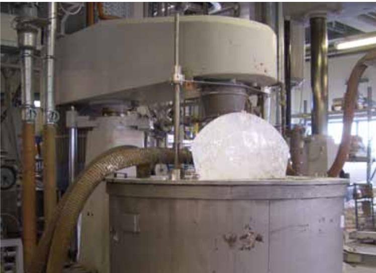
**Abbildung 7:** Deckel mit Zuschlagklappe und Absaugstutzen
