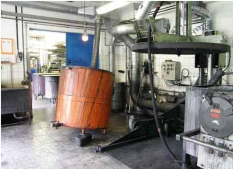
**Abbildung 11:** Räumlich getrennter Arbeitsbereich für Behälterwaschanlage, Hobbockreinigungsautomat und Handwaschbecken, mit RLT-Anlage und zusätzlichen Objektabsaugungen für manuelle Nacharbeiten bei der Behälterreinigung
