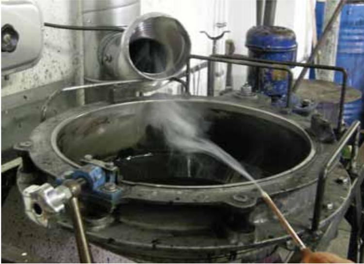
**Abbildung 4:** Überprüfung der Erfassungsqualität der Objektabsaugung mit Rauchröhrchen
