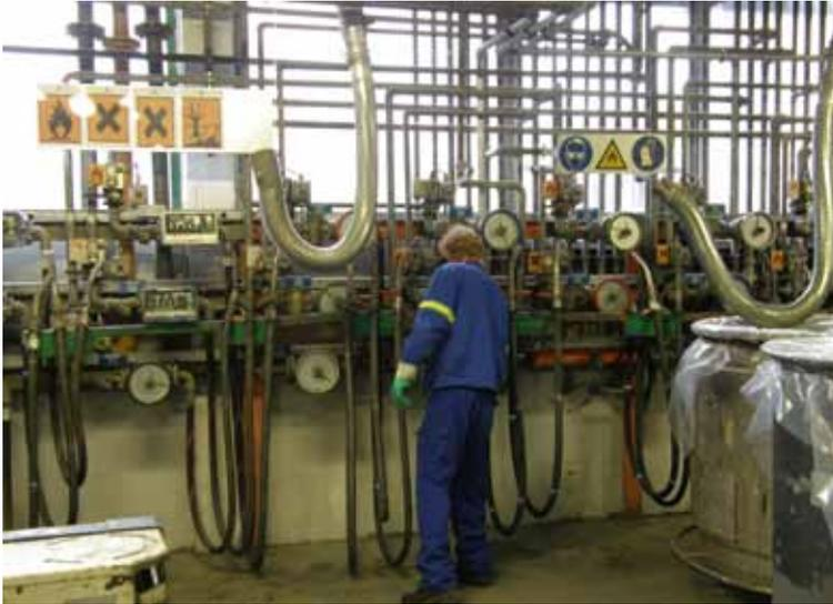
**Abbildung 9:** Lösemittelabfüllstation mit flexibler Objektabsaugung
