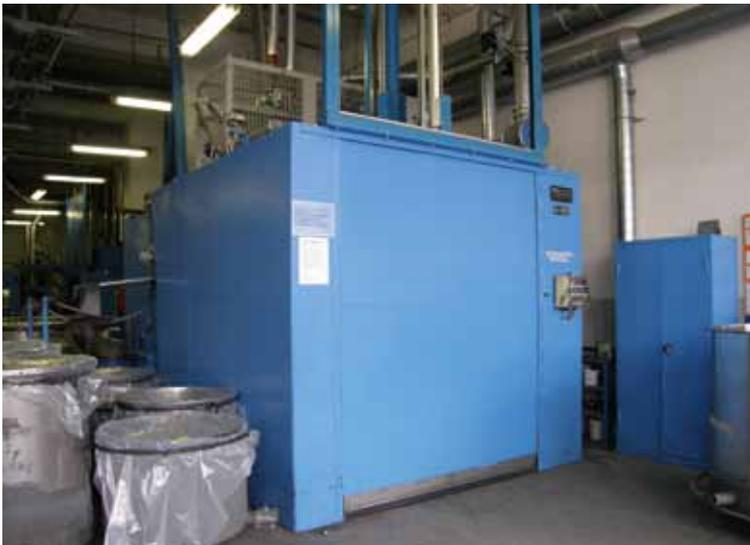
**Abbildung 12:** Vollautomatische Behälterwaschanlage
