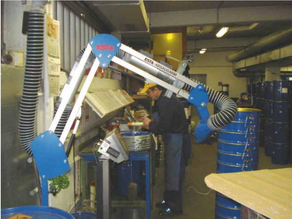
**Abbildung 1:** Gelenkarm zur Positionierung der Objektabsaugung
