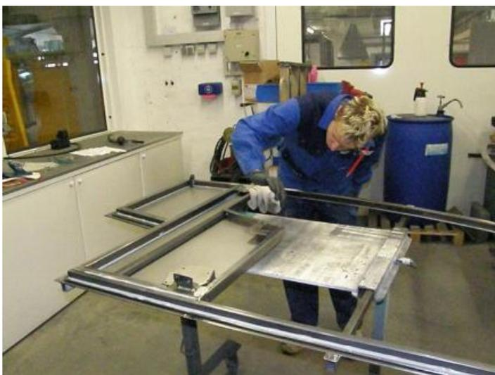
ABBILDUNG 1: ABWISCHEN VON WERKTEILEN MIT LÖSEMITTELHALTIGEM REINIGER
