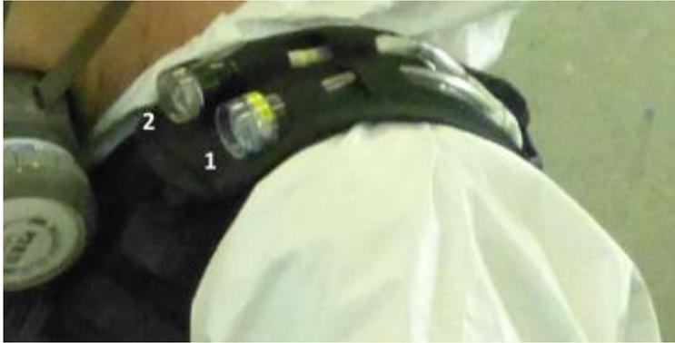
**ABBILDUNG 6: PARALLELE PROBENAHME VON LACKAEROSOLEN (PROBENAHMEKOPF; 1) UND LÖSEMITTELN (TENAXRÖHRCHEN MIT VORGESCHALTETEM GLASFASERFILTER; 2) BEIM SPRITZLACKIEREN**
