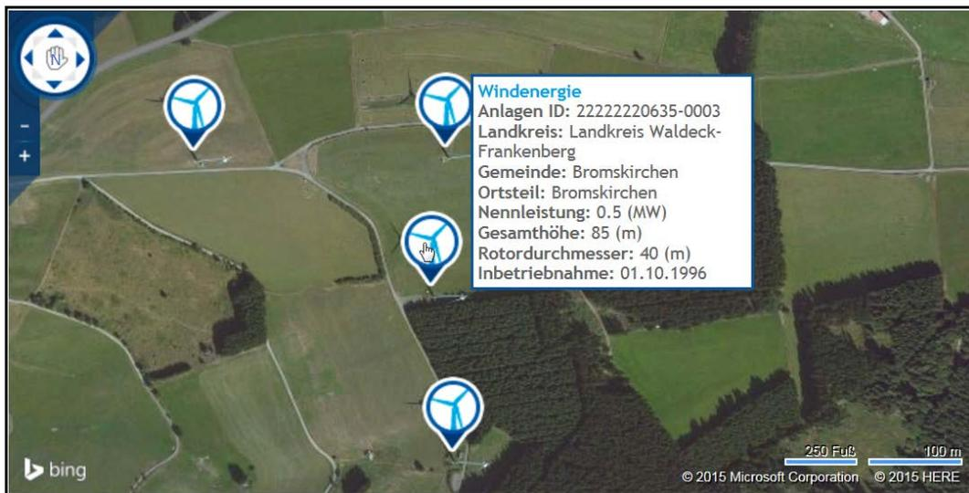
Abbildung 3 - Energiekarte: Beispielhafter Ausschnitt mit Anlageninformationen
