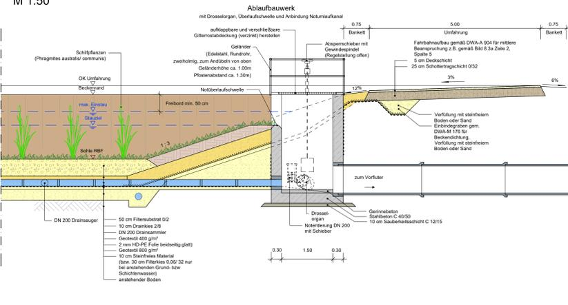
**Hydraulischer Längsschnitt E-E**
