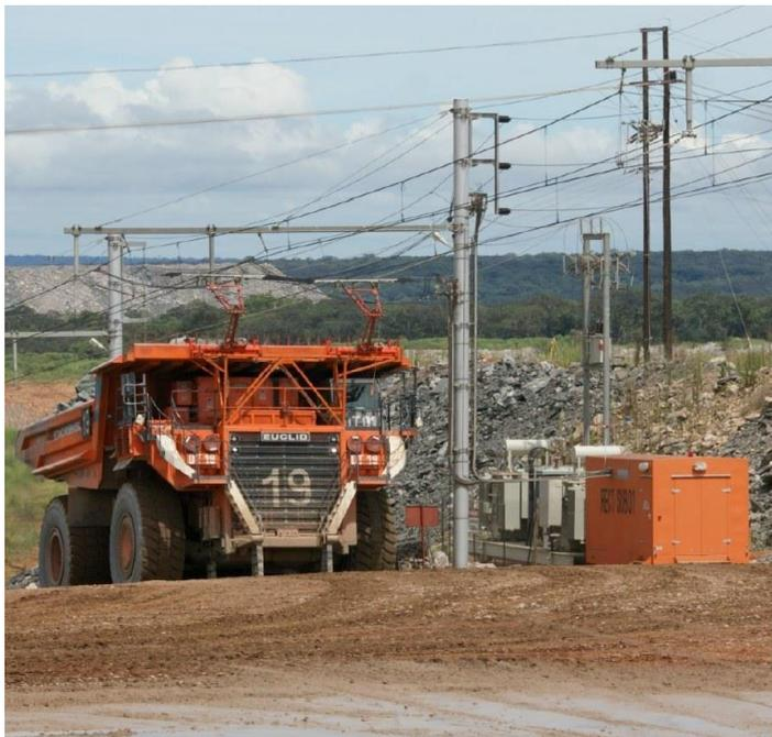
Abbildung 2-6 Anwendungsbeispiel Siemens Trolley Truck [4]
