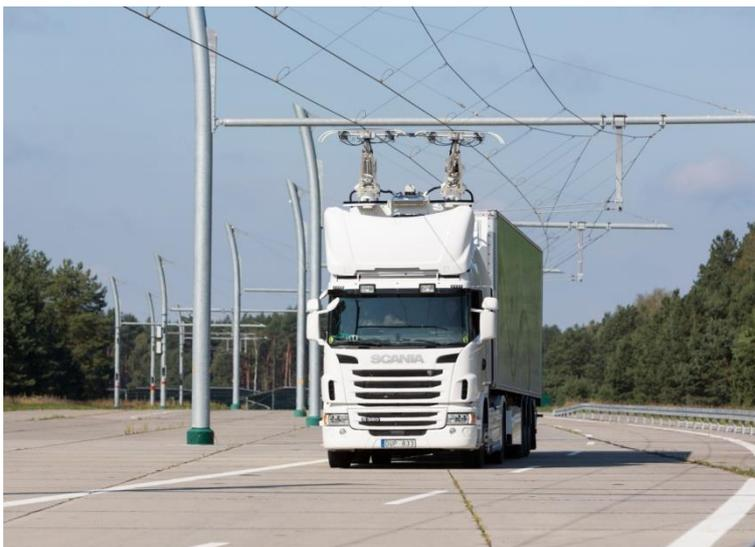
Abbildung 2-7: Siemens-Teststrecke (eHighway) auf einem ehem. Flugplatz in Brandenburg [2], [3]
