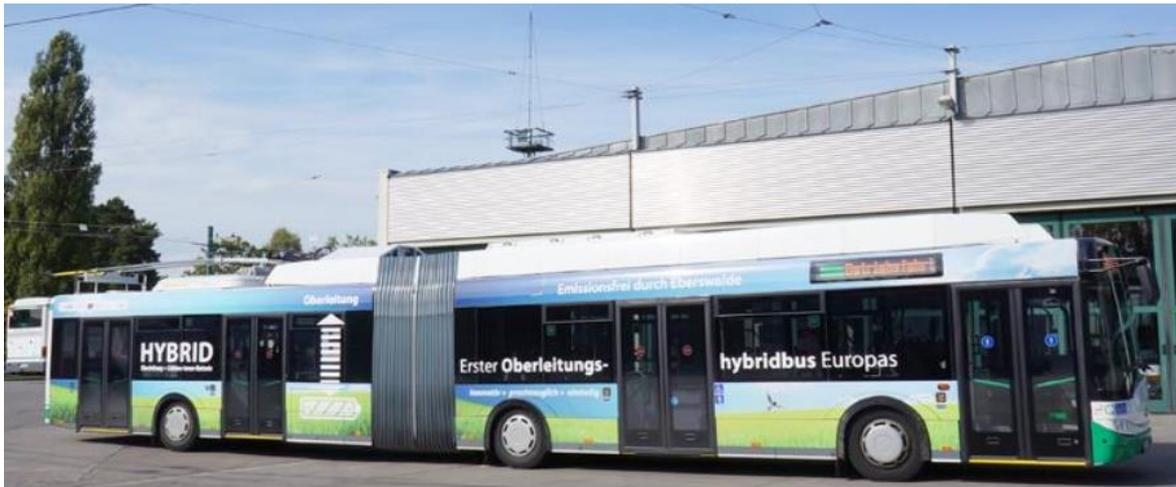
Abbildung 3-1: Batterieoberleitungsbus der BBG [22]
