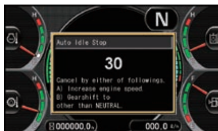
Die anpassbare Leerlaufabschaltung schaltet den Motor nach einer einstellbaren Zeitspanne im Leerlauf automatisch ab.
