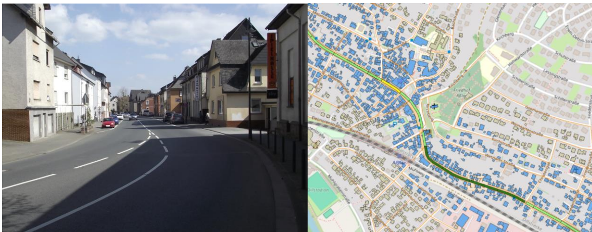
Abbildung 23 Bebauung entlang der B 277 in der Kernstadt (links) Visualisierung des Lärmkonfliktpunkts im Nachtzeitraum durch normierte Lärmkennzifferbänder (rechts) 62,63
