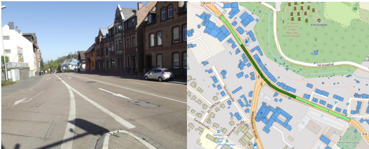
Abbildung 57 Bebauung entlang der B 8 in der Kernstadt (links) Visualisierung des Lärmkonfliktpunkts im Nachtzeitraum durch normierte Lärmkennziffernbänder (rechts) 109,110
