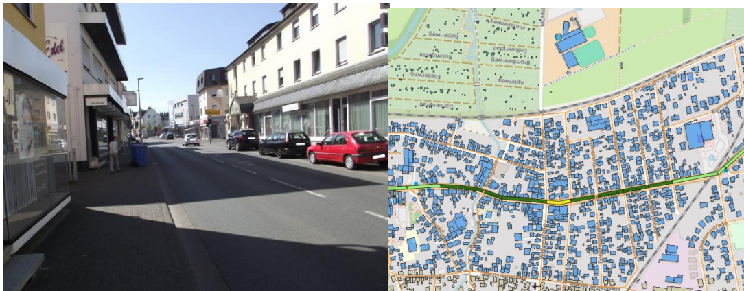
Abbildung 50 Bebauung entlang der B 8 in Elz (links) 101 und Lärmkennzifferbänder im Bereich der B 8 nach Berechnung des Lärmkonfliktpunktes (rechts) 100
