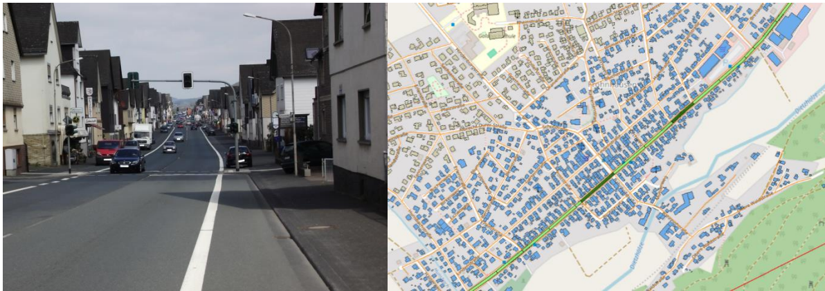
Abbildung 25 Bebauung an der Ortsdurchfahrt der B 253 in Frohnhausen (links) und Visualisierung des Lärmkonfliktpunktes durch normierte Lärmkennzifferbänder im Nachtzeitraum (rechts) 65,66
