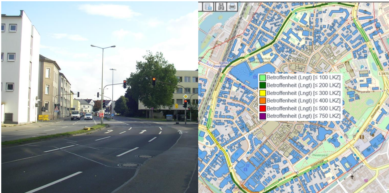
Abbildung 15 Typische Wohnbebauung am Anlagenring (links) und Visualisierung des Lärmkonfliktpunktes durch farbige Bänder der normierten Lärmkennziffern 53,54
