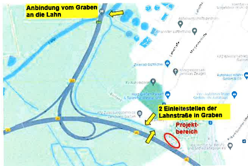
Bild 03: Ableitung Oberflächenwasser (Einleitungsstellen)
