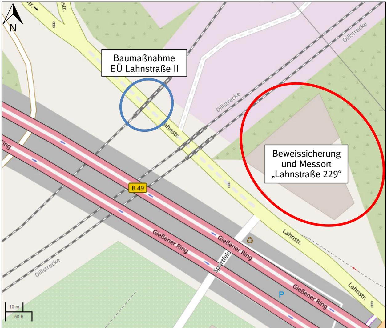
Abbildung 8: Empfohlenes Gebäude (rote Markierung: „Lahnstraße 229“) für eine Beweissicherung vor der Baumaßnahme und für baubegleitende Messungen während der erschütterungsintensiven Rammarbeiten mit Vibrationsramme [32].
