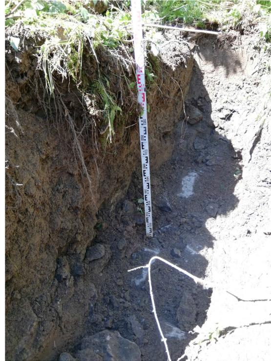
Bild 2: In rd. 1,3 m unter GOK verwitterter-frischer Basalt.
