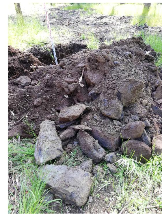
Bild 6: Aushubmaterial mit groben Basaltbruchstücken
