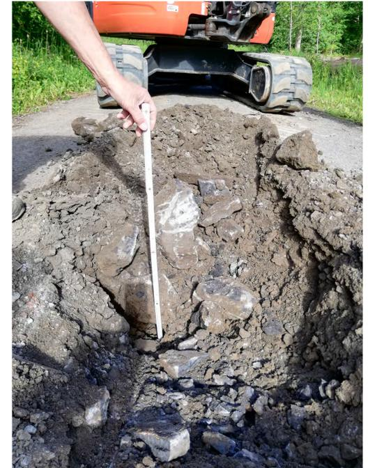
Bild 4: Schurf SCH 2 - bis in rd. 0,5 m Grobschlag aus Basaltbruchstücken.
