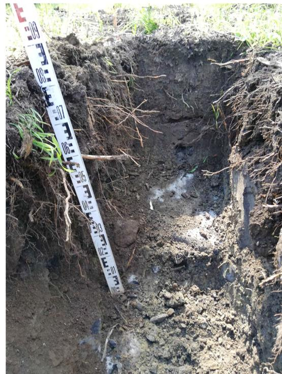
Bild 5: Bereits in rd. 0,8 m unter GOK verwitterter-frischer Basalt.
