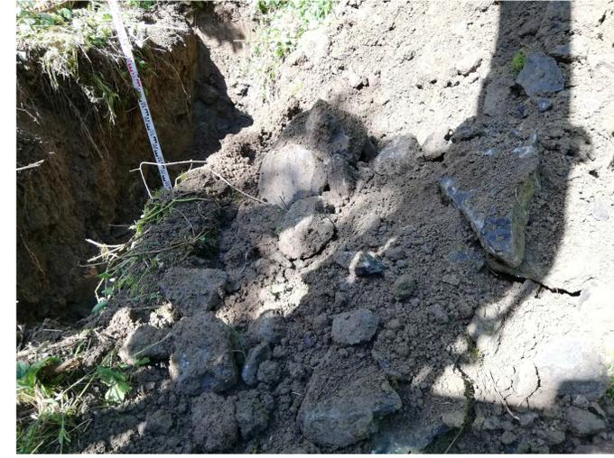
Bild 3: Aushubmaterial mit groben Basaltbruchstücken
