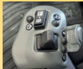
Komatsu Kurzhebel-Lenksystem (K-SLS) (optional)
