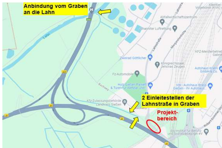
Bild 03: Ableitung Oberflächenwasser (Einleitungsstellen)
